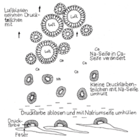
Bei der Flotation verbinden sich Farbpartikel mit Seife und binden sich an Luftblasen.
